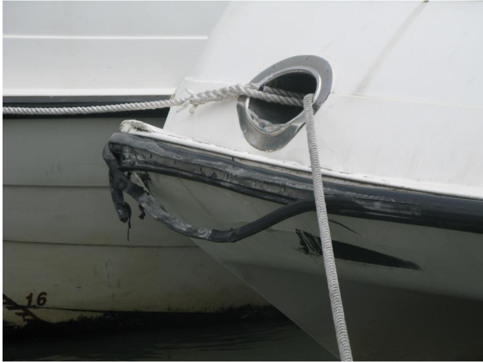
“名信 5”游览船船首破损照片
